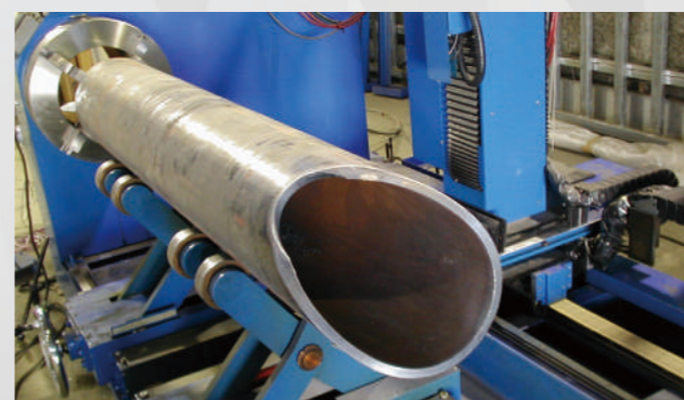
AWS開先切断 交差角度37度
