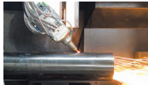
3次元ヘッドの能力を最大限に活用した開先付き切断機能 最大45度までの開先切断の設定が可能
