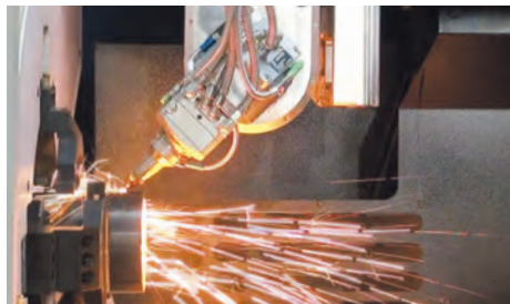
3次元ヘッドの能力を最大限に活用した開先付き切断機能 最大45度までの開先切断の設定が可能
