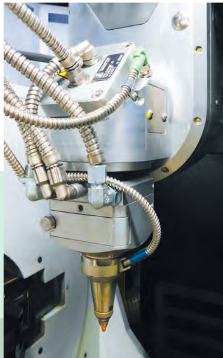
3次元ヘッドの能力を最大限に活用した開先付き切断機能 最大45度までの開先切断の設定が可能
